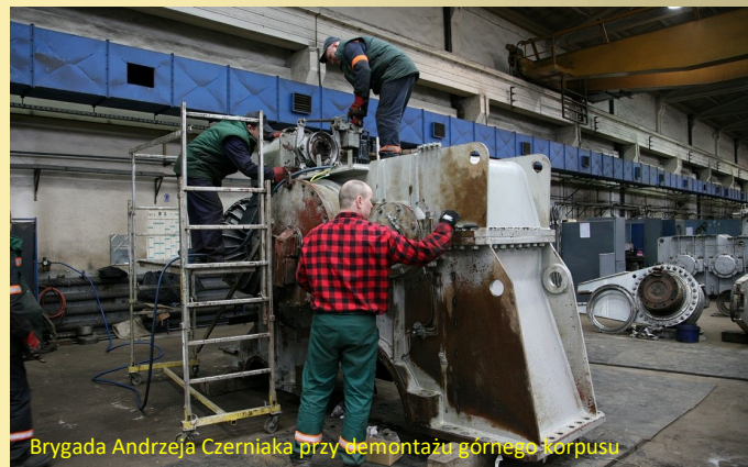
Demontaż górnego korpusu przekładni. Pracują (od lewej) Zbigniew Zawieruszyński i Piotr Lenartowski
